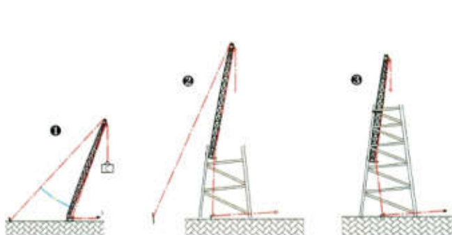
Niektóre "PRAWIDŁOWE" sposoby użytkowania "ZEWNĘTRZNY" przejścia linowego
